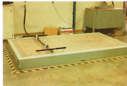
Ensayo de tablero bajo carga uniformemente repartida, aplicada en vacío. APA.
